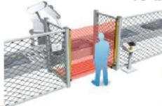
光軸はあっているように見えるけど、装置の振動等で急に停止することがある。
